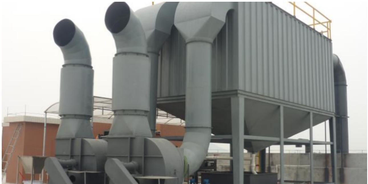
单机含尘气体进入箱体内，由扁布袋过滤器进行过滤，粉尘被阻留在滤袋外表面，已净化的气体通过滤袋进入风机，由风机吸入直接排出，随着过滤时间的增加，滤袋外面粘附的粉尘也不断增加，滤袋阻力也相应增大，从而影响了除尘效率，此时启动振打机构使粘附在滤袋表面的粉尘抖落下来，落在抽屉中的粉尘由人工拉出清理。单机除尘器的工作原理：含尘气体由进风口进入箱体，由滤袋进行过滤，粉尘被阻留在滤袋外表面，净化后的气体由风机经出风口排出箱体外，直接排入室内（亦可接风管排至室外）。随着主机连续工作，滤袋外面粘附的粉尘不断增加，使设备阻力不断上升，为此必须进行清灰，使粘在滤袋外面的粉尘抖落下来，经灰斗落至集尘器（抽屉）中，由人工清理。
